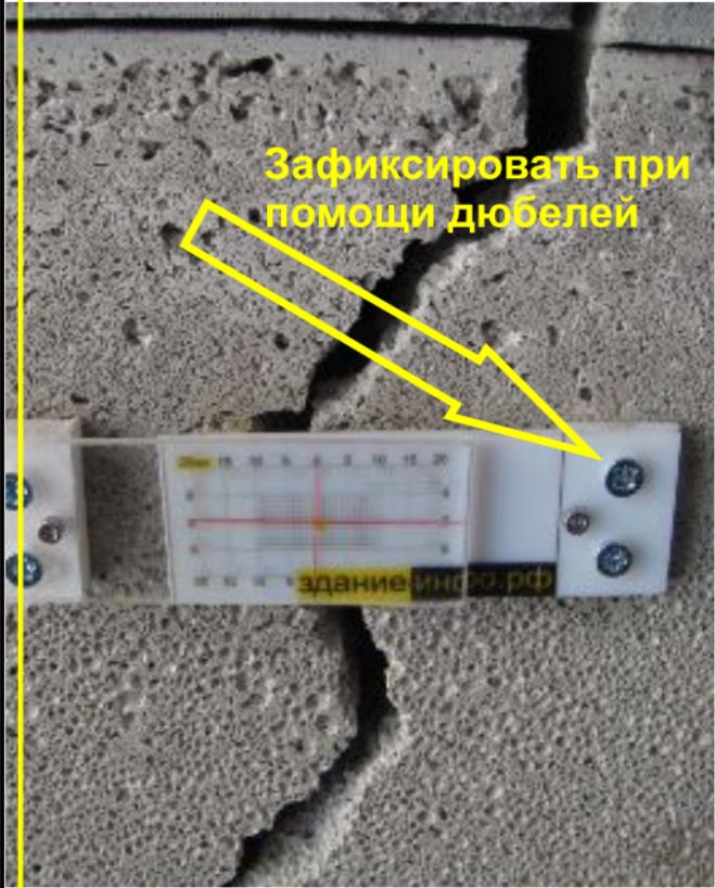
Закрепите маяк на конструкции при помощи дюбелей. При этом необходимо совместить указательный крест с нулевыми отметками линейки. Совмещение и крепление необходимо производить до схватывания клея, контролируя правильность совмещения строго перпендикулярно плоскости стены (визуально).
