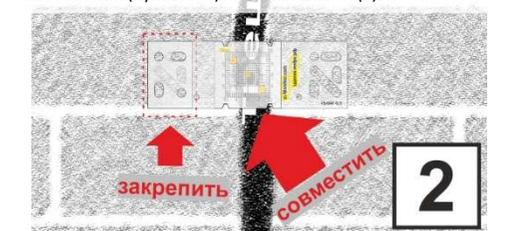
Затем крепится указательная пластина с другой стороны трещины. За счет более высокой установочной площадки она будет располагаться над пластиной со шкалой. Во время установки необходимо совместить красное перекрестье (2) с начальными (нулевыми) линиями шкалы (6).
