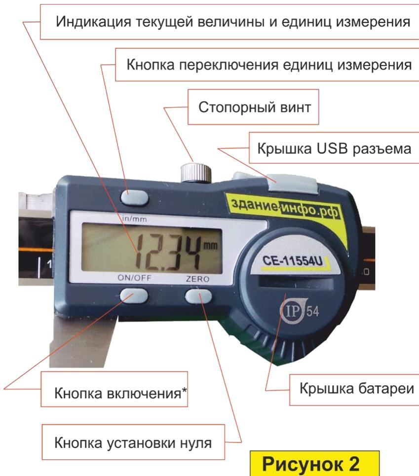
\* Кнопка включает и отключает дисплей. Автоматическое отключение дисплея происходит через 5 минут бездействия прибора. Текущее показание при автоматическом отключении сохраняется.
