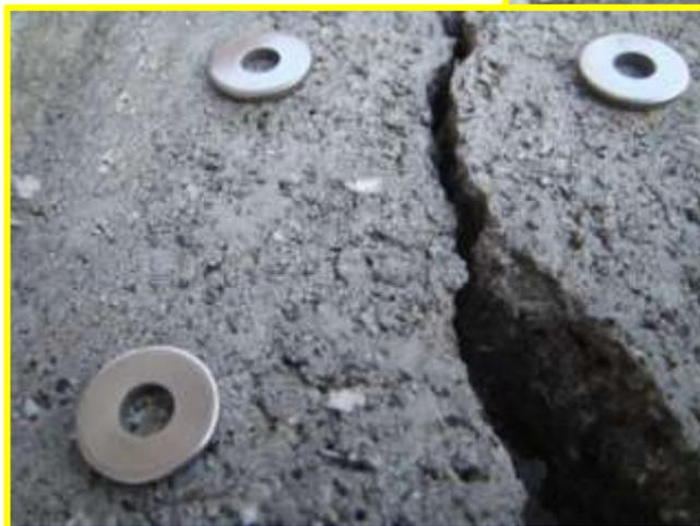
Способы и элементы фиксации точек могут быть различными и подбираются в зависимости от местных условий, задач и используемых для измерений инструментов. С каждой стороны трещины устанавливается по две точки наблюдений. Возможно наблюдение при общем количестве в 3 точки, но точность при этом может снизиться, а погрешность результатов увеличиться. Конкретное расположение точек на конструкции может быть любым, главное обеспечить удобство и точность измерений.
