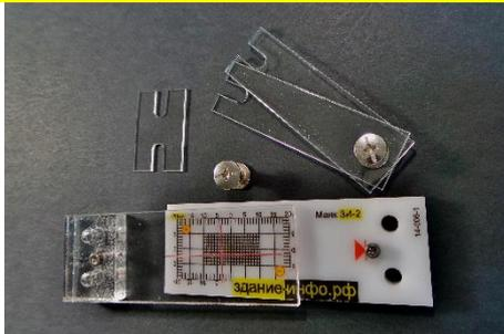
Для временной фиксации пластин маяка в нулевом положении используется струбцина и монтажная пластина (при необходимости).
