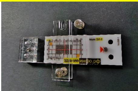
Регулировочные винты струбцины позволяют задать нужное расстояние между прижимными губками струбцины в диапазоне от 5,5 до 8 мм. При необходимости используйте подходящую по размеру крестовую или прямую отвертку.
